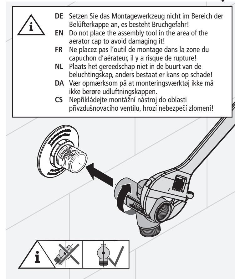
**DE** Setzen Sie das Montagewerkzeug nicht im Bereich der Belüfterkappe an, es besteht Bruchgefahr!
